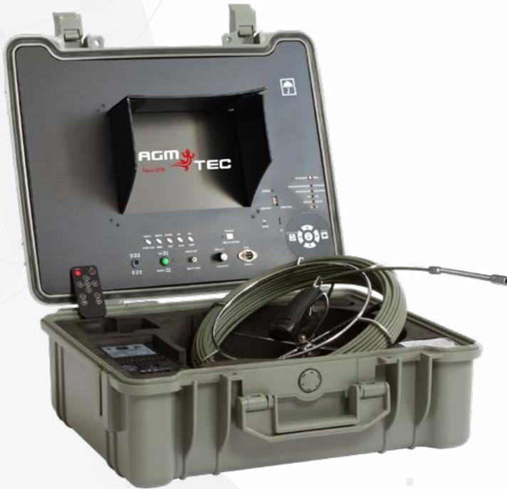
Utilisable par un seul opérateur, la caméra d'inspection Tubicam® R14 est idéale pour visualiser les petites canalisations et les tuyaux de piscines grâce à sa tête Ø14 mm sur des diamètres allant de Ø20 mm à Ø70 mm, jusqu'à 20 mètres de distance.
